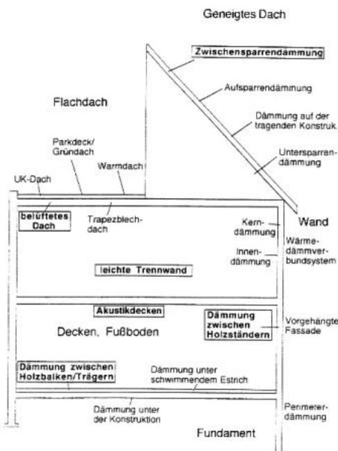
Abbildung 52: Einbaubereiche von Dämmungen im Gebäude (Deutsche Umwelthilfe e.V., 2020)
